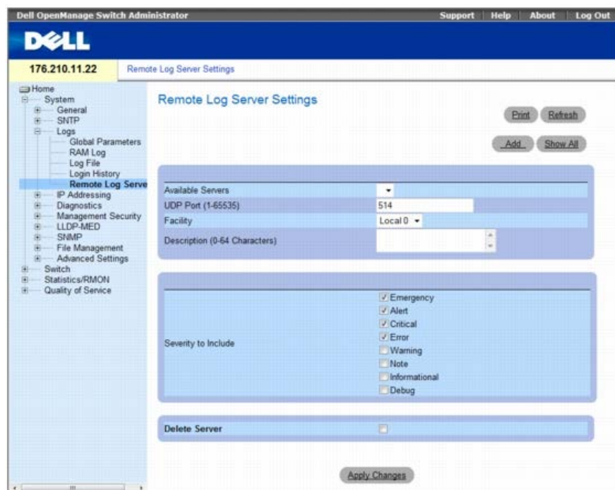
図 6-23. リモートログサーバーの設定
